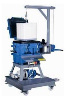
Модель ТЕ 5 для гальванических и химических процессов эффективная мощность: от 5 000 л / ч
